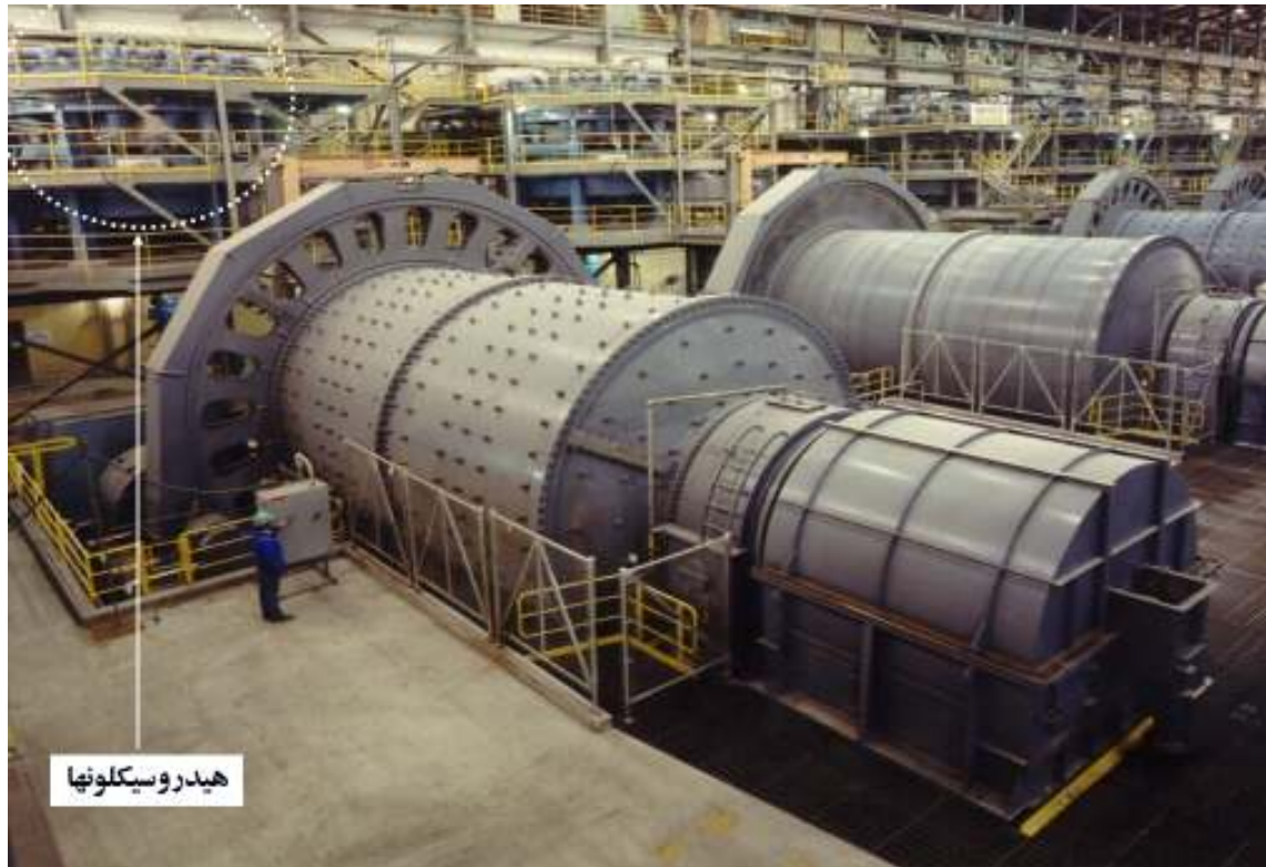
تصویری از آسیاهای گلوله‌ای مدار بسته با هیدروسیکلون
