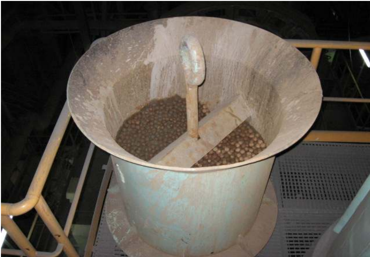
تصویری از مخزن شارژ گلوله در کارخانه‌های فرآوری مواد معدنی
